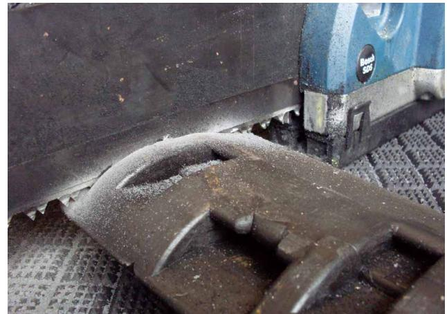
Bei Bedarf kann die Länge des Dämpfers an beiden Enden bis zu max. 30 mm mit einem geeigneten Schneidwerkzeug verringert werden.
