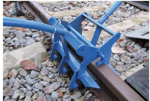
**Kontrolle: Der Schienenstegdämpfer befindet sich in finaler Position, wenn die Enden der Fixierdorne in etwa gleich weit hervorstehen.**
