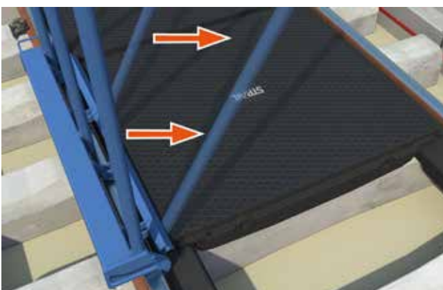
Den Plattenrand mit dem Einbauhebel zusammendrücken bis die Lippe unter den Schienenkopf rutscht.
