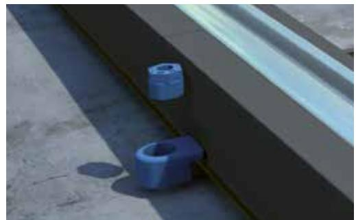
Das Innenteil der Exzenterklemme ist mit einem um 4 mm exzentrischen Bohrloch versehen und hat außen eine solche Form, dass es mit einem Maulschlüssel SW 46 im Außenteil sitzend gedreht werden kann.
